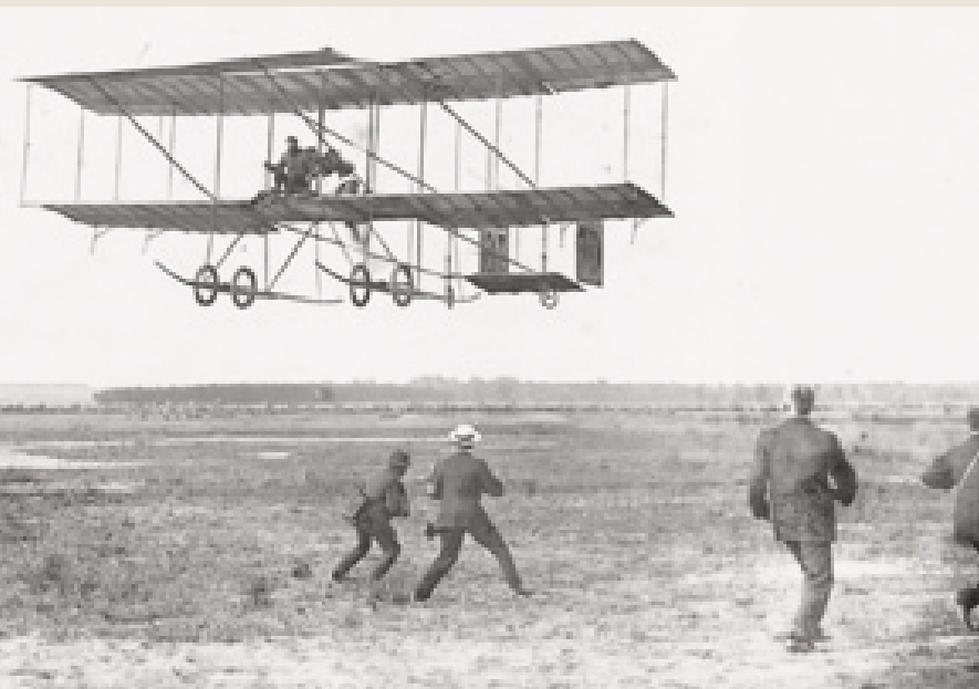
Au meeting de la Grande Semaine de Champagne, Henri Farman triomphe grâce au Gnome Oméga 50 ch qui équipe son appareil.
